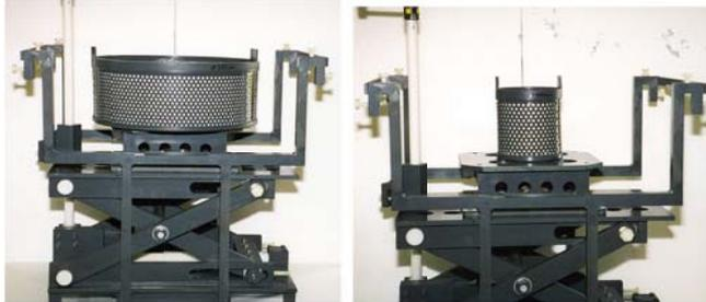
Flexible Montage von unterschiedlichen Diamantierkörben mit Bajonettverschluss
